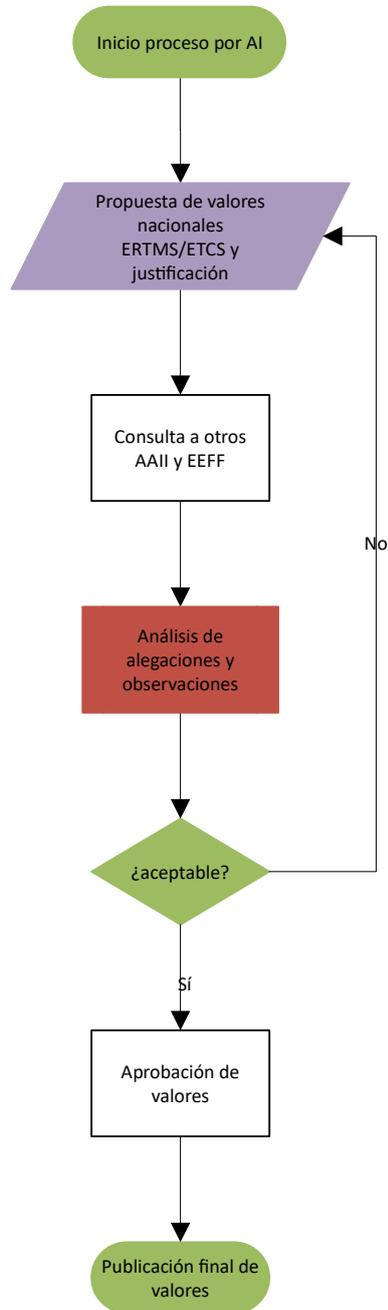
Ilustración 1: Flujograma de proceso para la adopción de valores nacionales aplicables al sistema ERTMS/ETCS.
