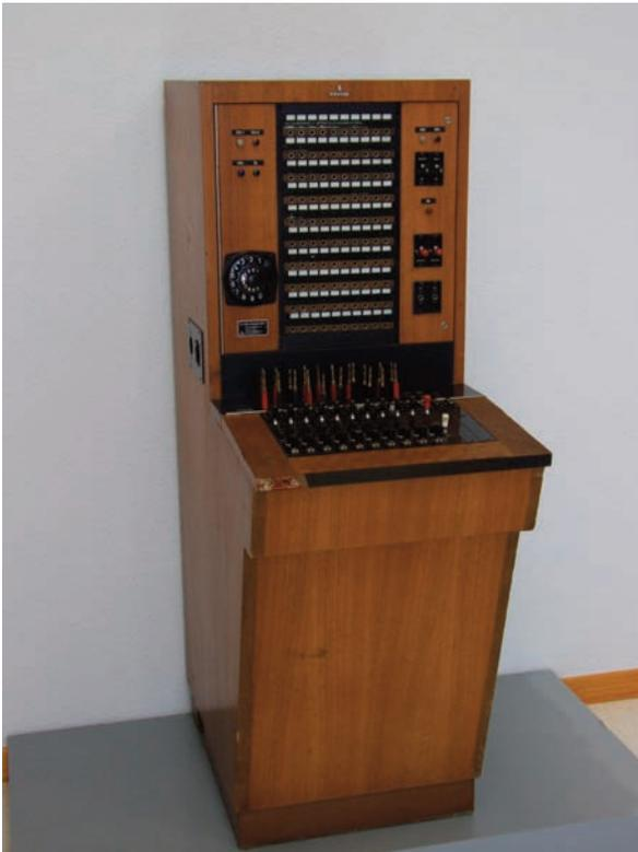
Centralita telefónica para conexión TELEX. Año 1961.
