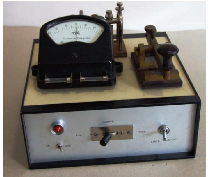
Estación morse para conmutar con teletipo *Olivetti*.
