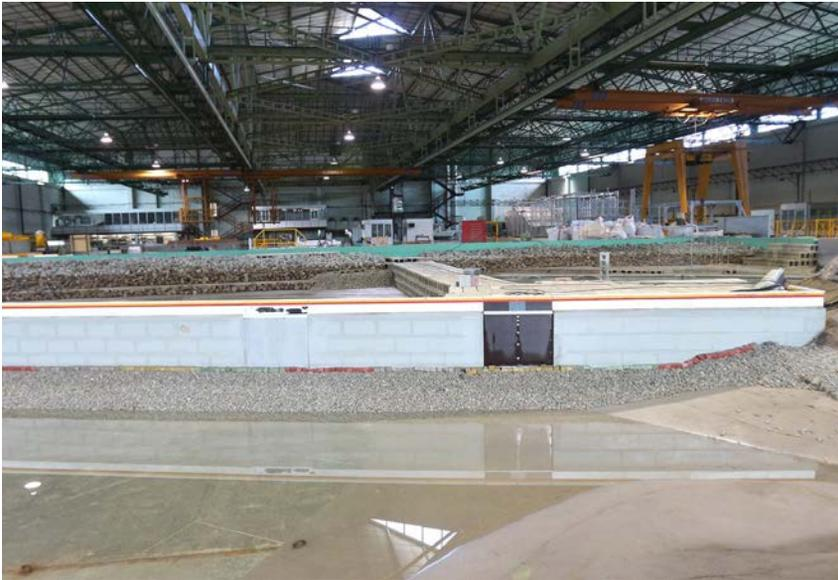
Ensayo presiones sobre el espaldón en el CEPYC .
