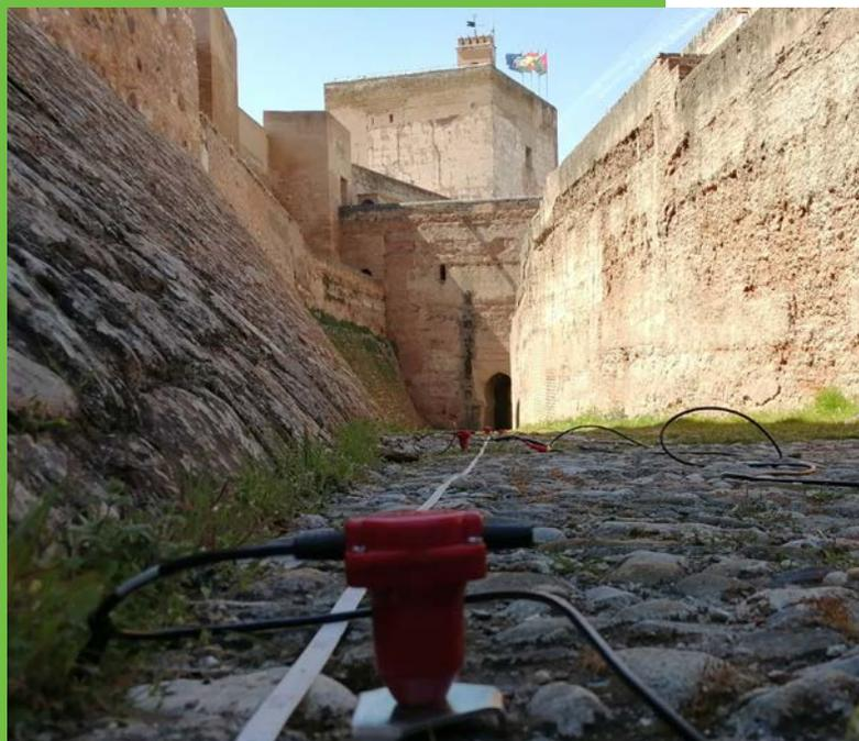
*Perfiles sísmicos en la Alhambra de Granada, próximos a la estación sísmica de aceleración situada en su interior.*
