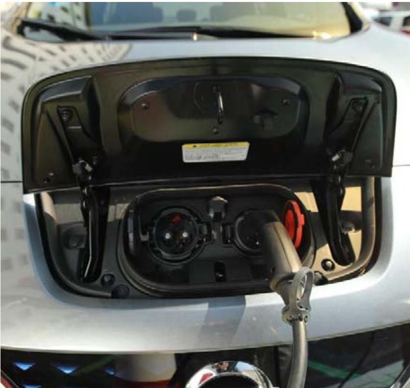
Vehículo eléctrico marca Nissan conectado al cargador
