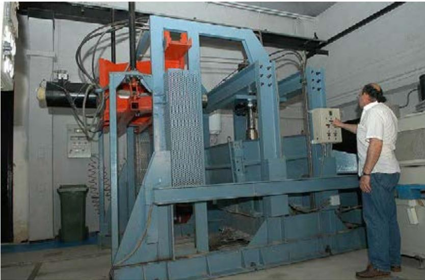
Caja de corte de metro cúbico del laboratorio de Geotecnia.
