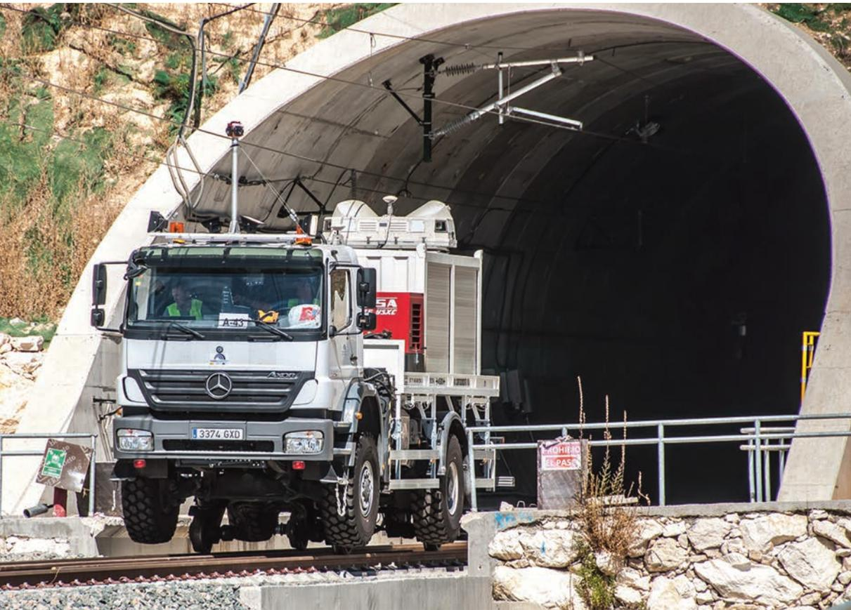
► El prototipo, de tipología bivial, ante la boca del túnel de Quejigares, en la línea de alta velocidad Antequera-Granada.
