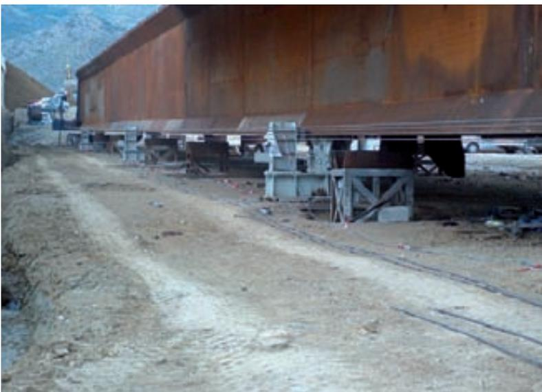
► *Viga preparada para realización de pruebas de carga.*
