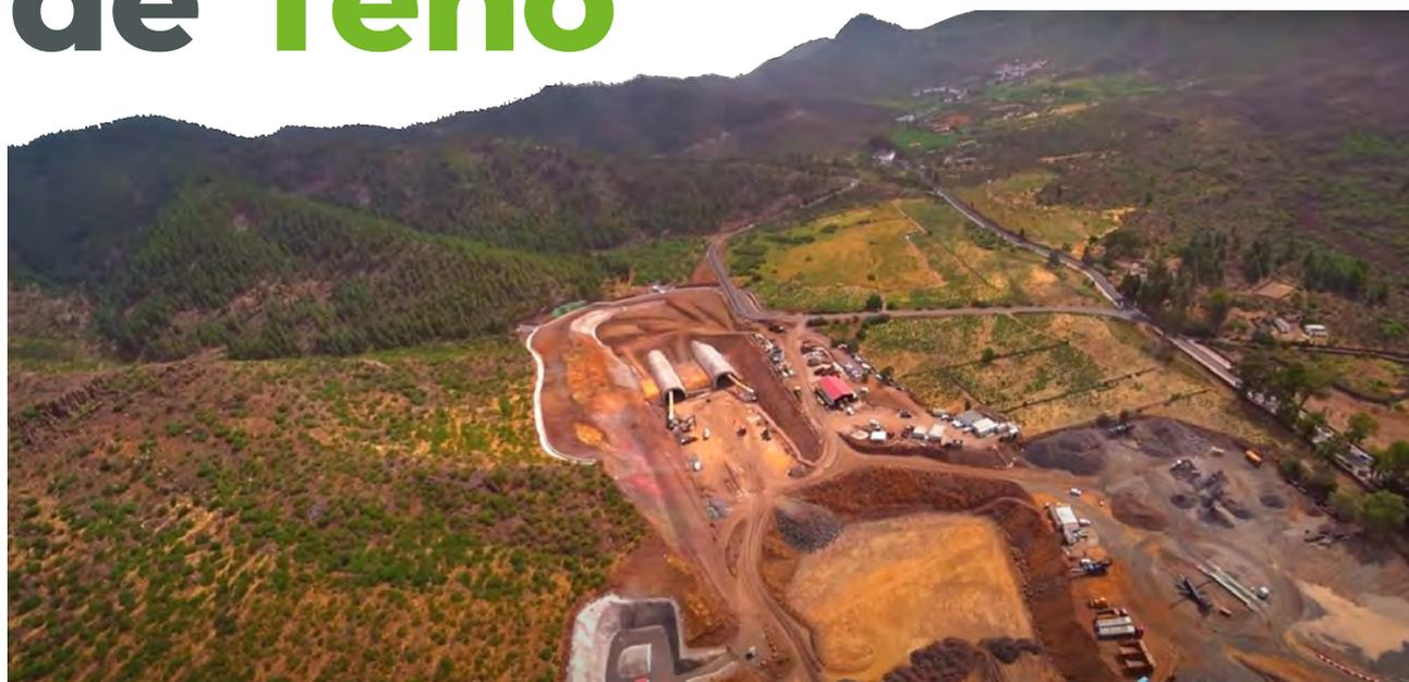
El pasado verano se produjo el cale de los dos tubos del túnel de Erjos, un importante hito en el proyecto de cierre del Anillo Insular de Tenerife. La excavación de este túnel de carretera ha supuesto un gran desafío tanto por su longitud (con 5,1 km, es el mayor de Canarias y uno de los más largos de España) como por las particularidades geológicas y geotécnicas del terreno perforado. La obra se financia con cargo al Convenio de Carreteras suscrito entre Mitma y el Gobierno insular.
