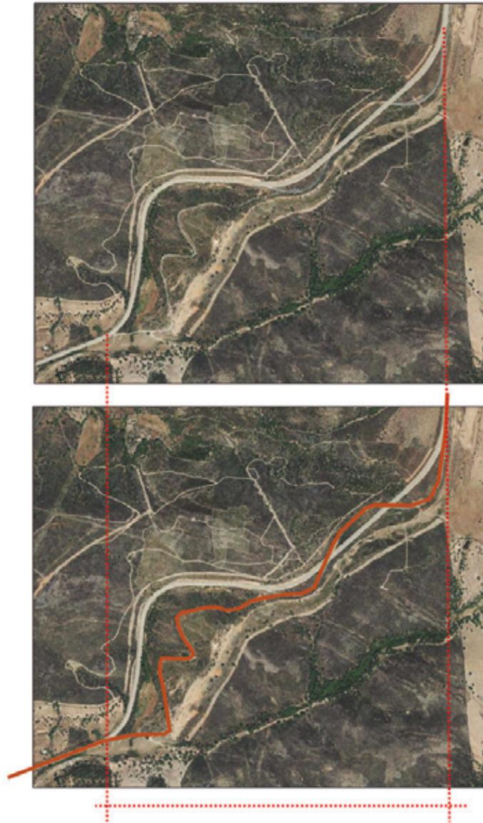
Figura 14. Segmentos del trazado histórico entre los pk 217+700 y 219+200, en el subtramo 3.3. Conservan elementos del Circuito Nacional de Firmes Especiales. Están abandonados, son transitables y tienen buen acceso desde la carretera en servicio.
