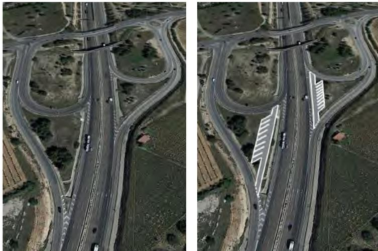
Figura 10. Zona de detención segura en una nueva vía colectora. Fuente: Adaptada de Google
