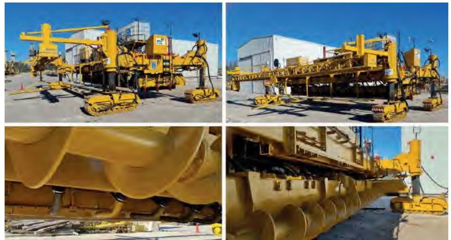
Figura 10. CMI SF-450 para el hormigón magro y la capa inferior del pavimento bicapa (Fuente: FCC)
