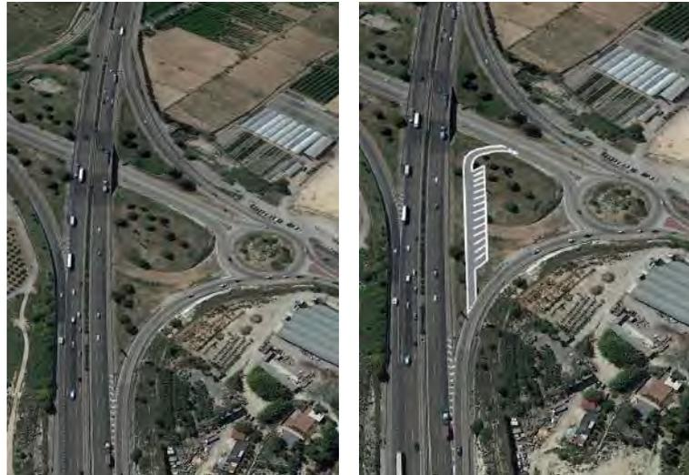
Figura 12. Zona de detención segura en un nuevo ramal de uso específico. Fuente: Adaptada de Google
