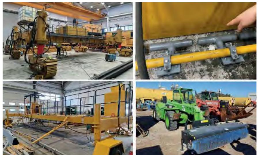
Figura 11. Puesta a punto de la extendidora CMI SF-350 (arriba), carro de curado (abajo izqda.) y equipo de barrido (Fuente: FCC)
