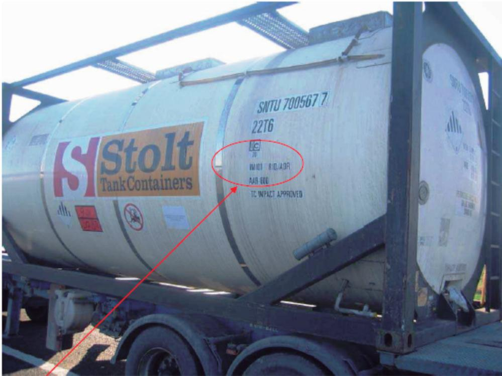
Como se puede observar se trata de una cisterna portátil al estar homologada como IMO 1 (líquidos) con una presión máxima de trabajo  $\geq 1,75$  bar
