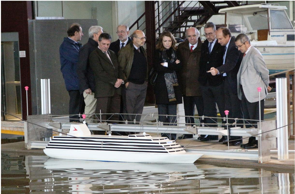
Ensayo de movimientos en buques atracados
