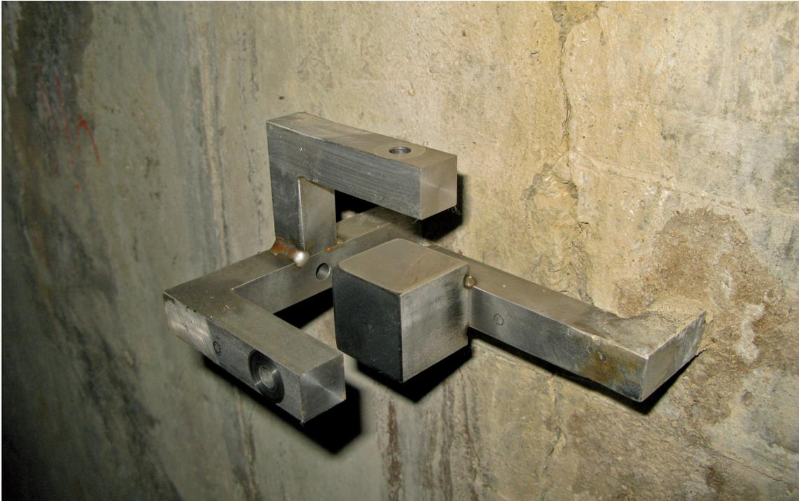
Medidor de movimientos tridimensionales entre juntas de bloques, instalado en galería
