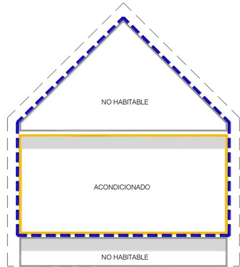
— Trazado de la envolvente térmica OPCIÓN 1 CONFIGURACIÓN 2
