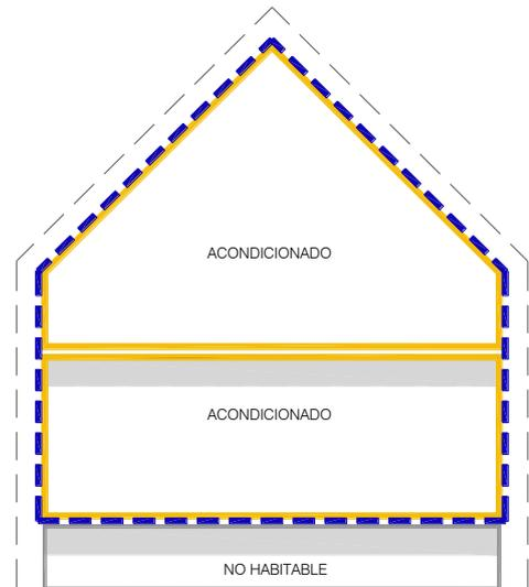
— Trazado de la envolvente térmica OPCIÓN 3 CONFIGURACIÓN ÚNICA
