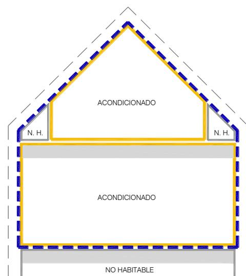
— Trazado de la envoltente térmica OPCIÓN 2 CONFIGURACIÓN 2
