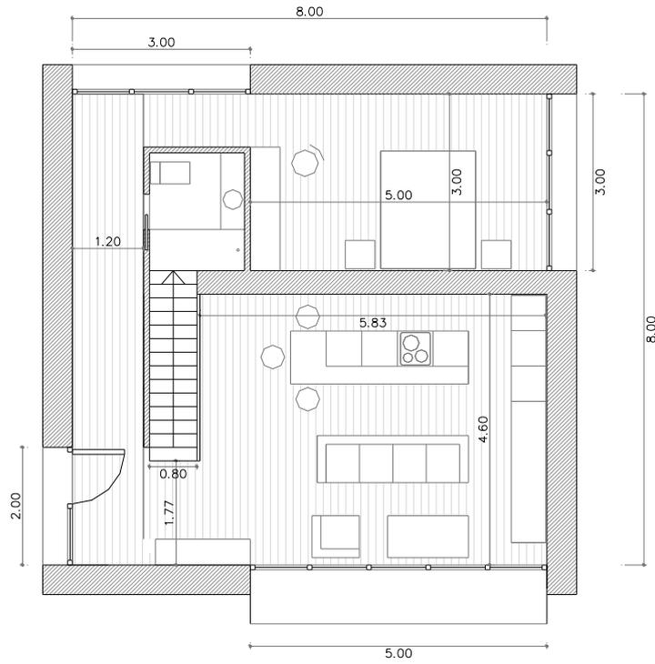
PLANTA BAJA - Superficie útil interior a la envolvente 64 m<sup>2</sup>
