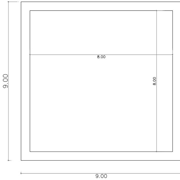
NIVEL CÁMARA SANITARIA - Superficie útil interior a la envolvente 64 m<sup>2</sup>
