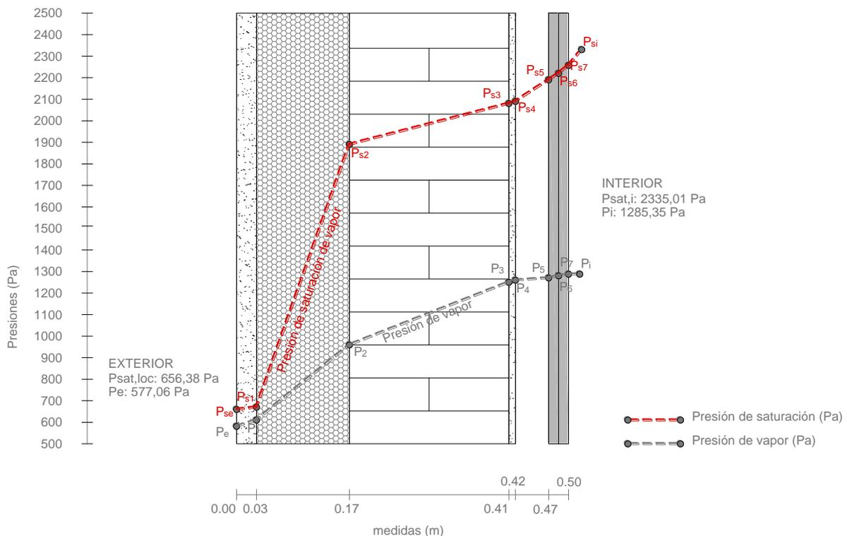
Como se observa en la gráfica no existe contacto entre ambas gráficas por lo que se puede concluir que para las condiciones exteriores (mes de enero) e interiores establecidas, no se producen condensaciones intersticiales en ninguna de las capas que forman el cerramiento analizado.
