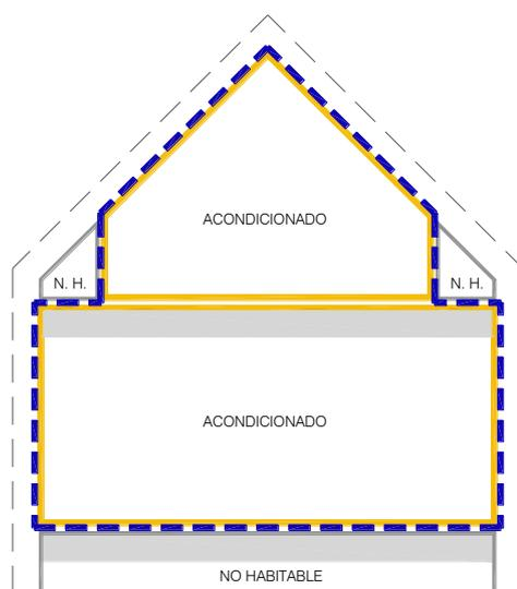
— Trazado de la envoltente térmica OPCIÓN 2 CONFIGURACIÓN 1
