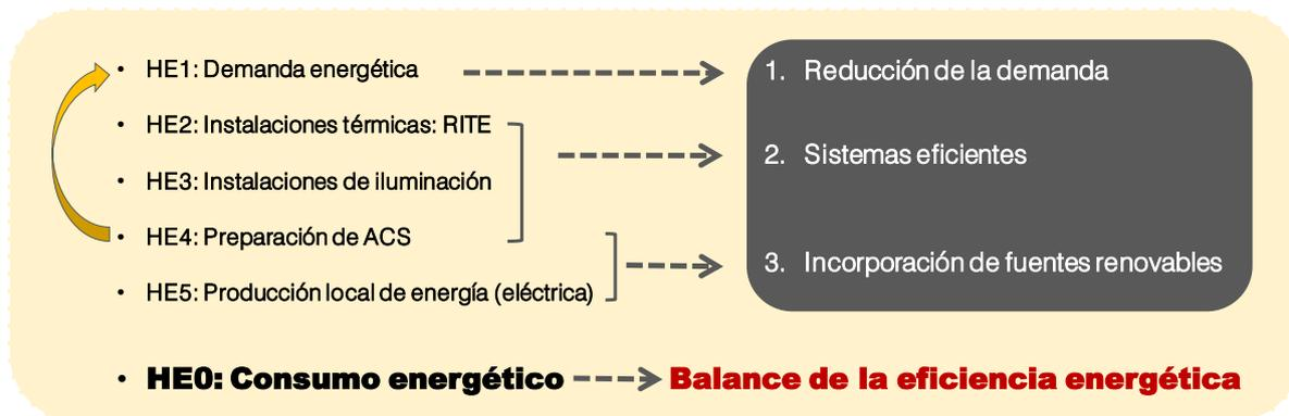
Completarían la estructura, la demanda derivada de la necesaria renovación de aire (ventilación), que para el interior de las viviendas se recoge en el documento básico de salubridad HS 3 “Calidad del aire interior”, mientras que, para otros usos se recoge en el RITE.
