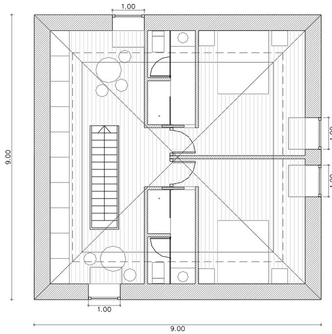
PLANTA BAJOCUBIERTA - Superficie útil interior a la envolvente 64 m<sup>2</sup>
