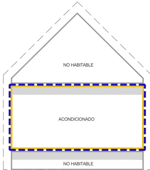
— Trazado de la envolvente térmica OPCIÓN 1 CONFIGURACIÓN 1
